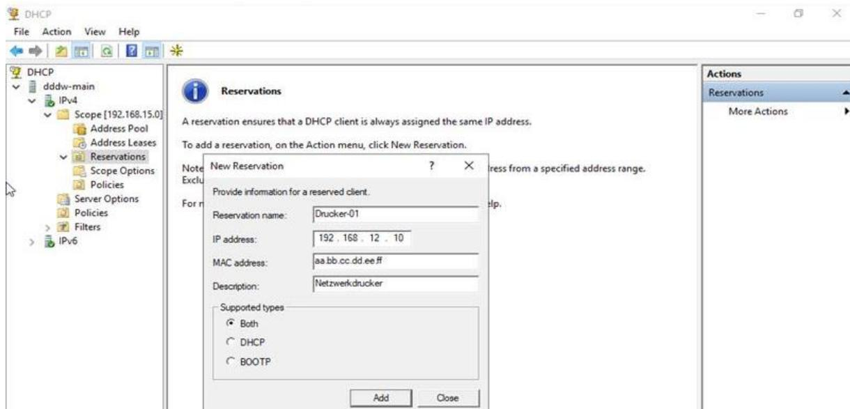
Und machten das gleiche für die Weiteren Geräte. Sodass alle Geräte die richtige Konfigurationen haben mussten wir in den Scope Optionen den Router und den DNS festlegen sodass alle neuen Geräte den Richtige DNS server und Router nehmen.
